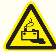
Batterij lekkage Batteries: source de danger
