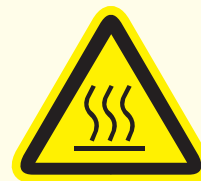
Heet oppervlak Surface chaude
